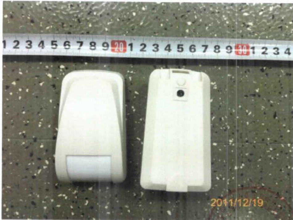
图一、NS-CP6D 室内用被动红外入侵探测器外部结构
