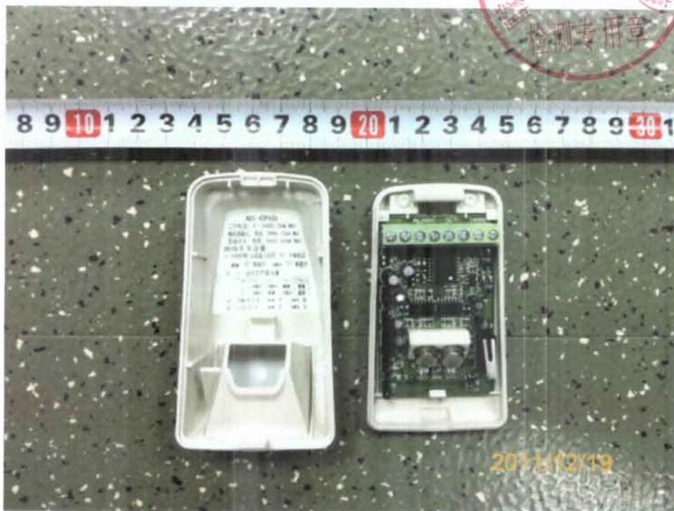
图二、NS-CP6D 室内用被动红外入侵探测器内部结构
